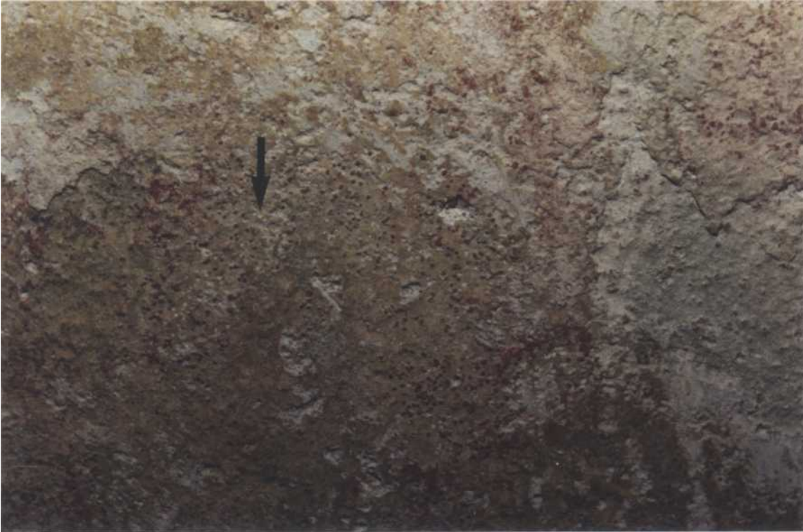
Abb. 64: Rote "Erhebungen" im Nordgewölbe des Westjochs, Idensen. In der Mitte befindet sich die Probennahmestelle. Der Pfeil deutet auf punktförmige Hohlräume in der Malerschicht. Bildbreite ca. 8cm.
