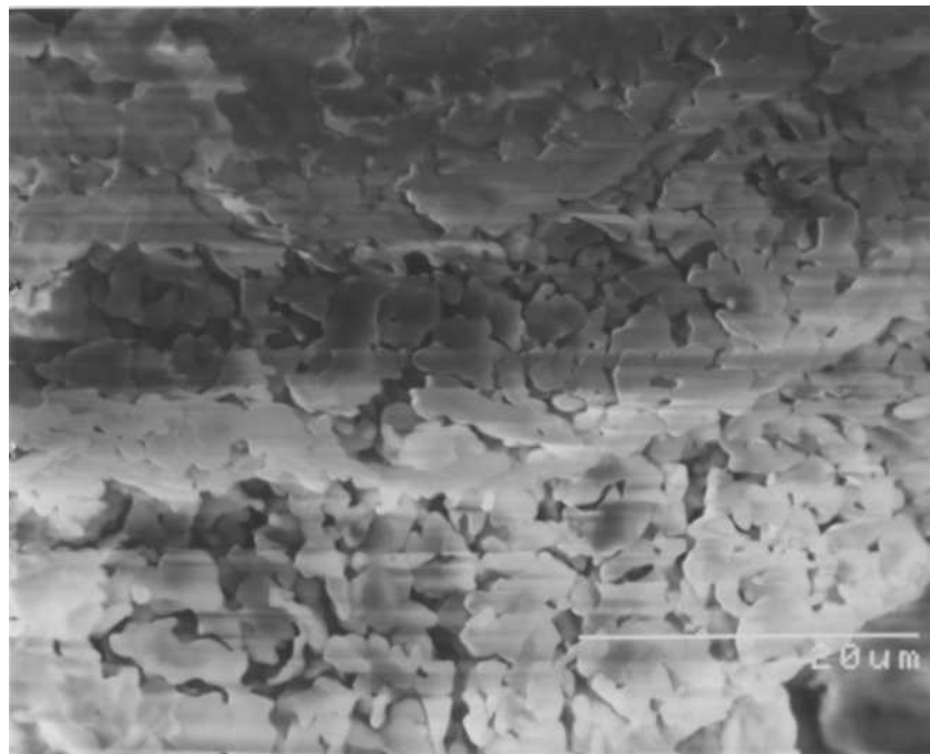
Abb. 75: Vergrößerte Darstellung der Thenarditkristalle eines dehydratisierten Mirabilits.
