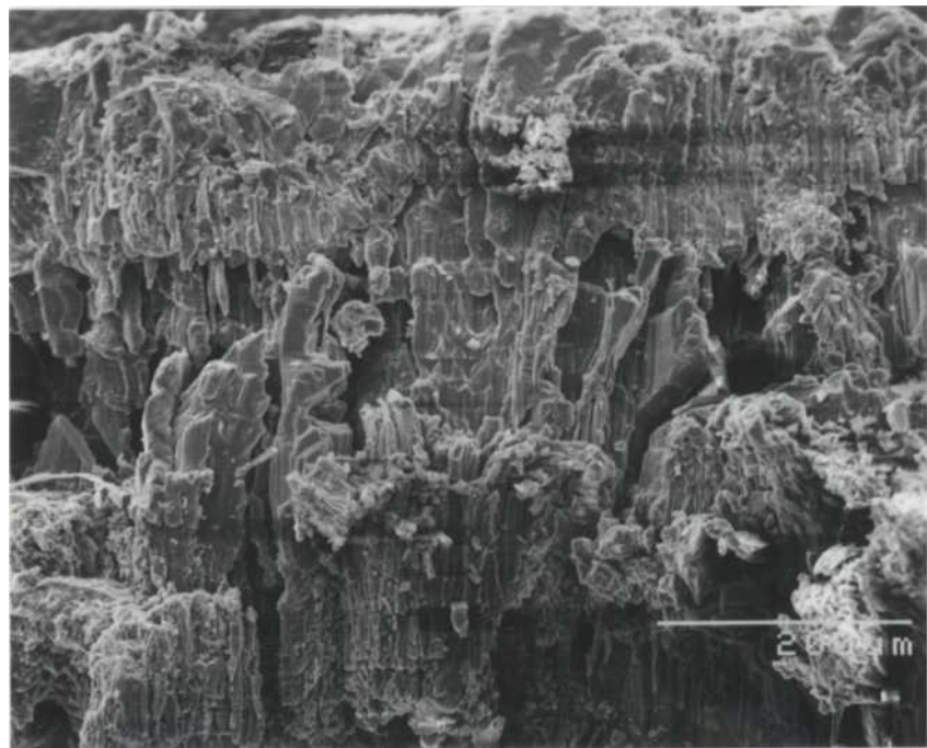
Abb. 31: Querbruch der Gips-Sinterkruste vom Typ II. Sie repräsentiert eine Faserkruste aus dicht gepackten, säulenförmigen Kristallen und ist mehrlagig aufgebaut.
