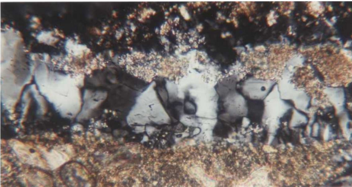
Abb. 45: Ausschnittsvergrößerung der Abb. 44. Die ca. 80 \mu m dicke Gipskruste wird aus einer dünnen Lage prismatischer bis isometrischer Kristalle und einer darüberliegenden Lage aus großen Tafeln aufgebaut.
