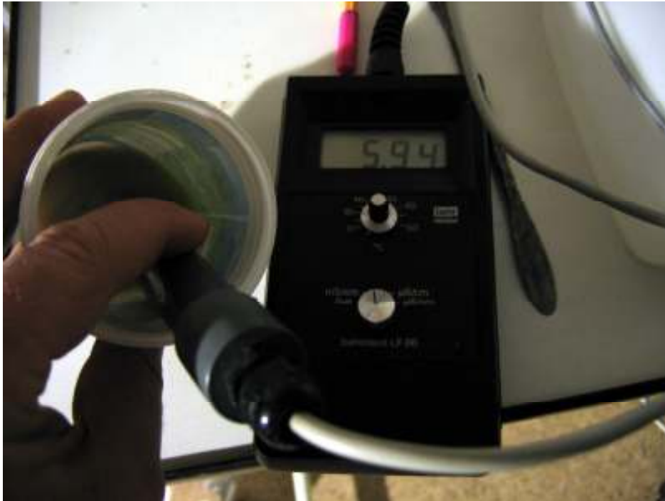
Abbildung18: Leitfähigkeitsmessgerät der Firma Behr (Foto: Markus Eiden, genehmigt durch Hubertus Fürst Fugger-Babenhausen und die Fürst Fugger-Babenhausen´sche Stiftung zur Förderung schwäbischen Kulturgutes)
