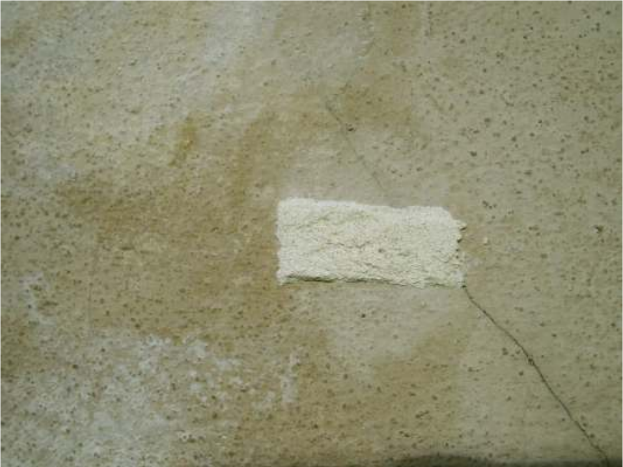
Abbildung 6: Residenz Würzburg, Treppenhausfresko, Detail Gewölbe-Ost , Vorversuche zur adsorptiven Reduktion von ausgeschwemmten Feinstbestandteilen (ggf. in Kombination mit löslichen Salzen) (Foto: M. Eiden, genehmigt durch Bayerische Verwaltung der staatlichen Schlösser, Gärten und Seen, Schloss Nymphenburg, 80638 München)
