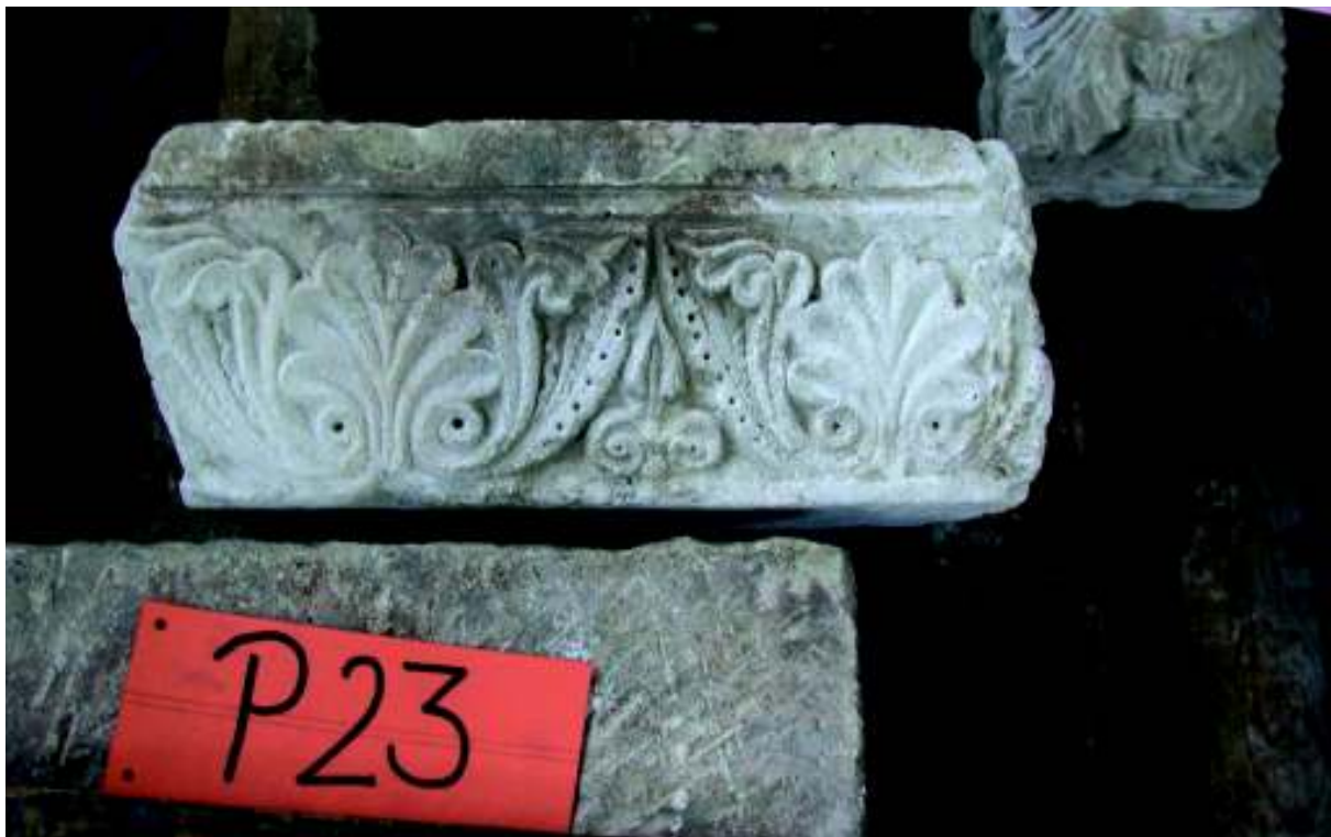
Abbildung 28: Fallbeispiel zur Wirkung des Abbürstens von Salzausblühungen: Analysen des abgebürsteten Materials und der Salzverteilung im Tiefenprofil ermöglichen eine grobe Abschätzung, dass aus diesem Kalksteinkapitell durch das Abbürsten ca. 20 M.-% der Salze entfernt wurden, während 80 M.-% im Porenraum des Steins verblieben. (Foto: M. Auras)
