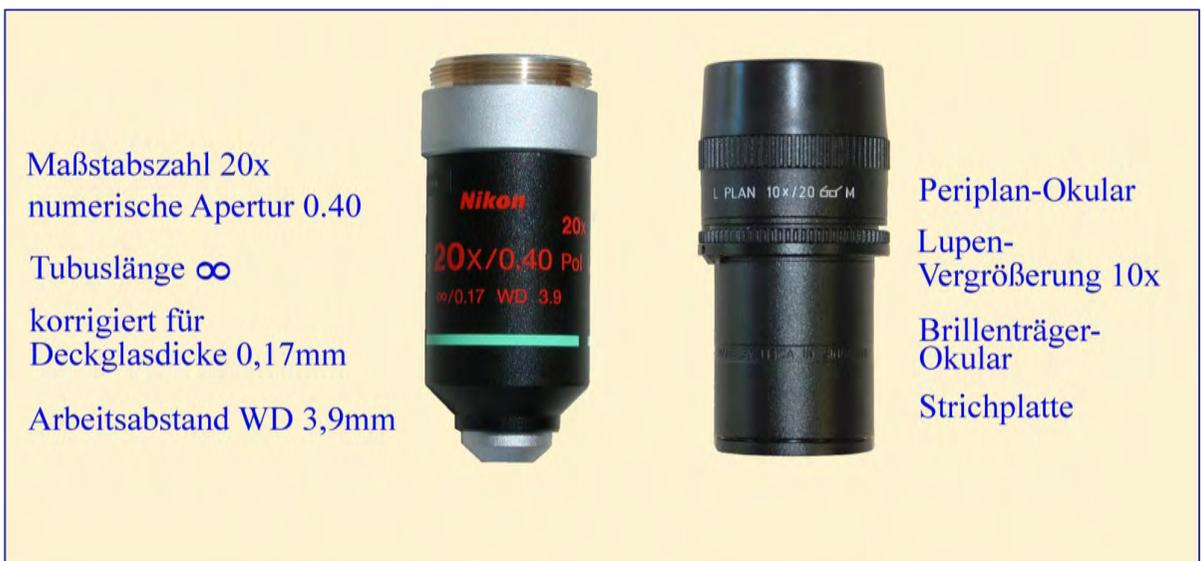
Abbildung 1.2-2: Objektiv (Beispiel: Nikon CFI Achromat 20x P) und Okular (Beispiel: Leica Periplan m. Strichplatte)
