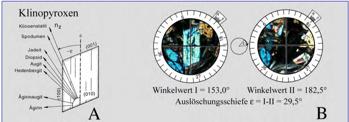
**Abbildung 4.2.4-2:** Auslöschungsschiefe in Klinopyroxen
