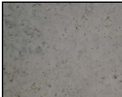
Abb. 46: Steinoberseite nach der Entsalzung mittels einer kaolin-haltigen Kompressen 250-fache Vergrößerung
