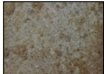
Abb. 48: Steinoberseite nach der Entsalzung mittels einer sepiolithhaltigen Kompressen 250-fache Vergrößerung
