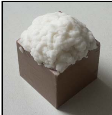
Abb. 16: Versuchskörper mit kaolinhaltiger Entsalzungskompressen
