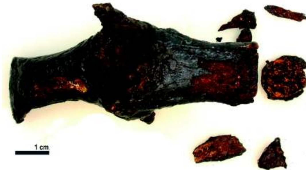
**Abbildung 12: Römischer Hammerkopf, wenige Jahre nach Restaurierung ohne Entsalzung (Foto B. Schmutzler, SABK)**
