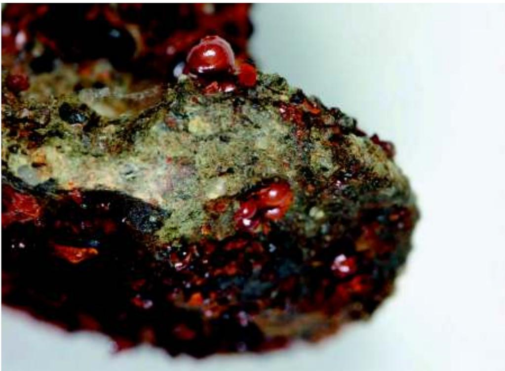
**Abbildung 13: ‚Weinendes Eisen‘; Eisenchloridtropfen auf einem mittelalterlichen Nagelkopf (Foto: I. Wiesner, SABK)**
