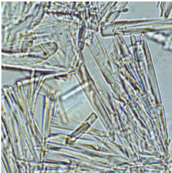
Abbildung 8 - Beckesche Lichtlinie an längliche Kaliumnitratkristallen. Die untere Bildkante entspricht ca. 0,5 mm.
