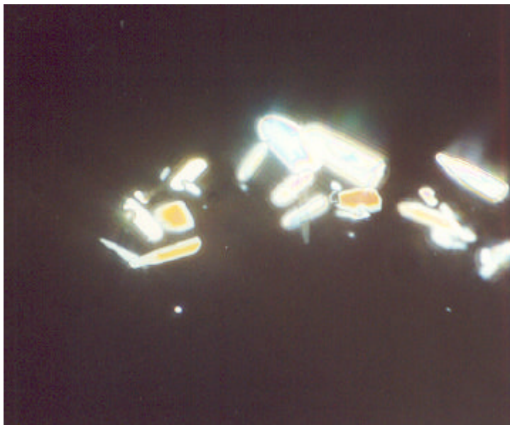
Abbildung 87 – Rekristallisiertes Mischpräparat Thenardit/ Mirabilit.
