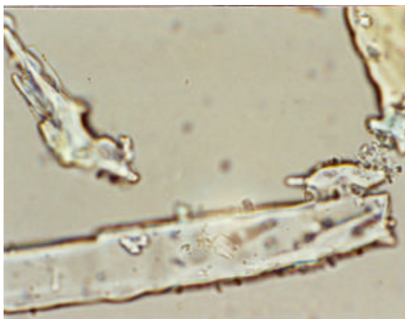
Abbildung 27 – Dickenbestimmung eines Kristalls, unterer Fokussierpunkt.
