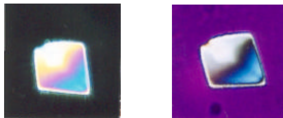
Abbildung 16a und 16b - Bildbeispiel Subtraktionsstellung. Nitronatriit. Die untere Bildkante entspricht ca. 0,5mm.
