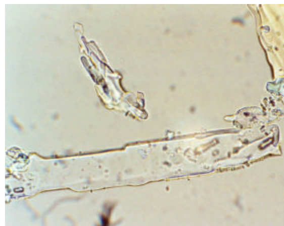
Abbildung 28 - Dickenbestimmung eines Kristalls, oberer Fokussierpunkt.
