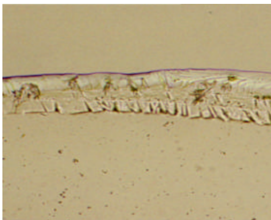
Abbildung 23 – Zustand nach abgeschlossener Rekristallisation. Die unteren Bildkanten der Abbildungen 21-23 entsprechen ca. 0,5 mm.
